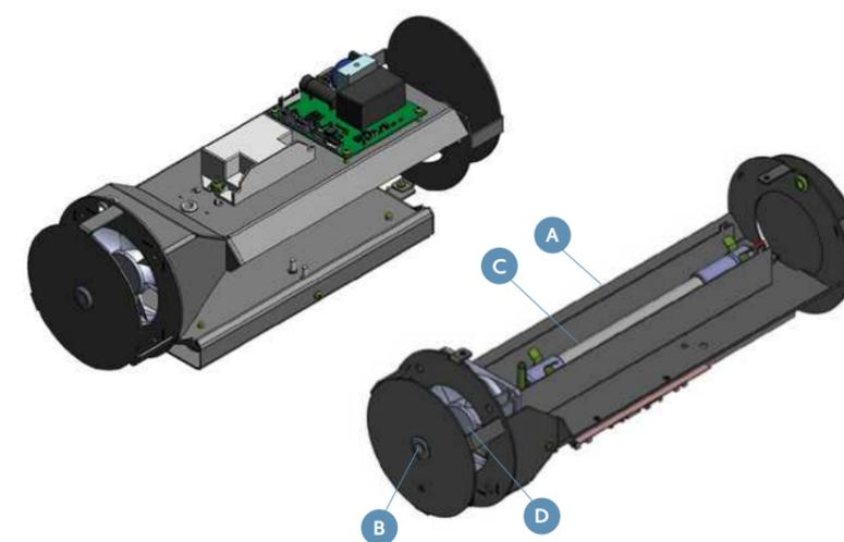
A Gehäuse · B An- / Aus-Druckschalter mit blauer Kontrollleuchte · C UV-C Spezialleuchte · D Ventilator
